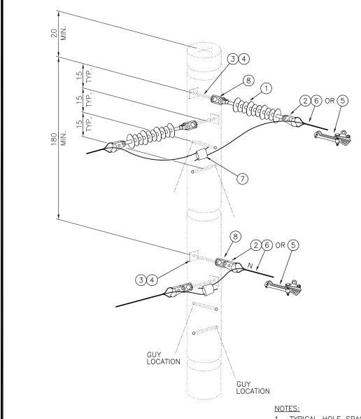
TYPICAL HOLE SPACING FROM 15cm CAN BE REDUCED TO 10cm FOR ATTACHMENT HOLES AT RIGHT ANGLE.
