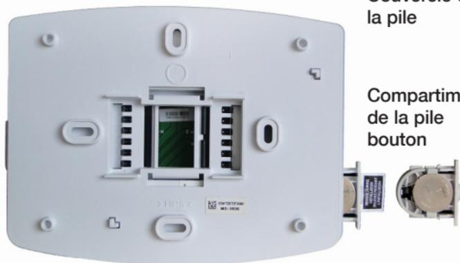
Insérez la pile bouton dans le compartiment de la pile bouton et poussez-le à l'intérieur du couvercle de la pile.
